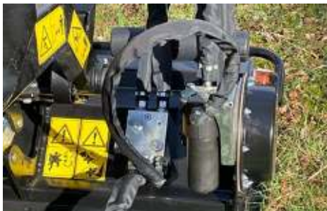
Bloc hydraulique de sécurité avec filtration par cartouche
