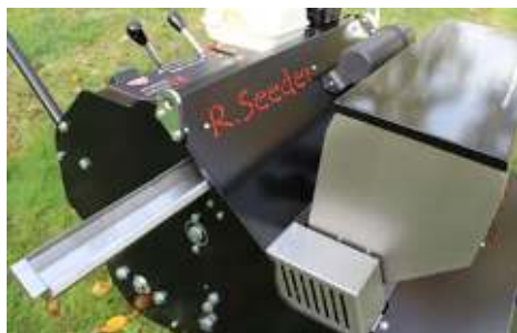
Auget pour l'égalonnage du dépôt de semences
