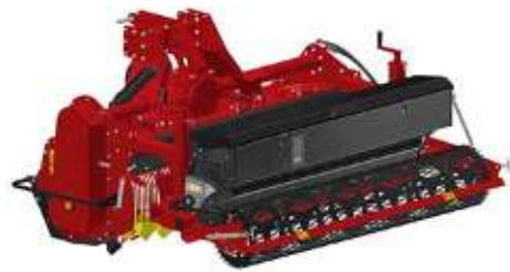
Option : Semoir inox à distributeur à cannelures
