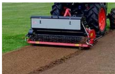
Option : Semoir inox à distributeur à cannelures
