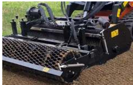
Option : Déplacement hydraulique du châssis rouleau
