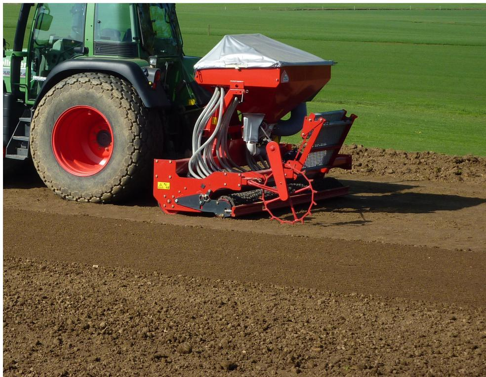
Cet engazonneur a été conçu pour semer la plupart des variétés de gazons comme les pâturages, les fétuques, ray-grass, etc. sur de grandes surfaces. Il est équipé d'un semoir pneumatique et de deux rouleaux fonte, permettant un engazonnement en un seul passage. Il s'utilise sur terrain préalablement travaillé à l'aide d'un préparateur de sol / enfouisseur de pierres.
