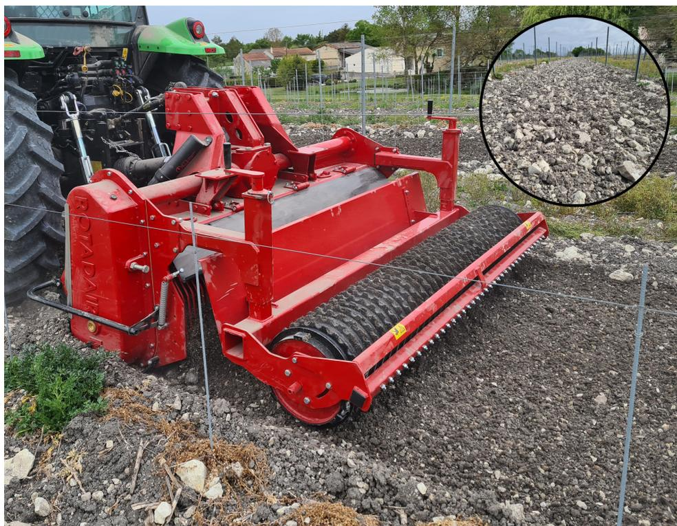
Ce préparateur de sols et enfouisseur de pierres permet la création ou la rénovation d'espaces verts en préparant le lit de semences avant l'engazonnement. La machine est multi-usage, elle permet de fraiser, d'enfouir (pierres, détritux, herbes ...), de niveler, de malaxer et de rouler la surface. L'utilisation se fait en direct ou sur un terrain préalablement décompacté en profondeur.
