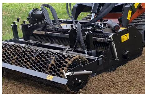
Option : Déplacement hydraulique du châssis rouleau
