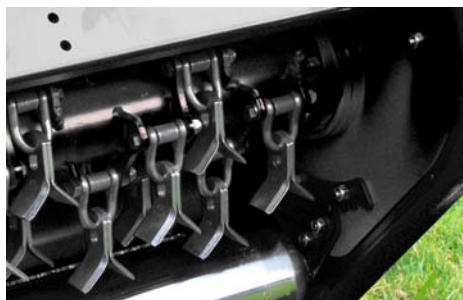
Montage en Y des couteaux sur manilles
