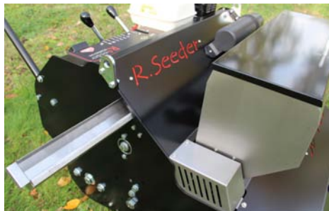
Auget pour l'égalonnage du dépôt de semences
