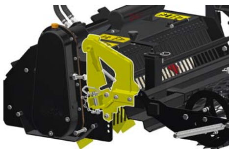
Option : Accrochage / Décrochage rapide du châssis
