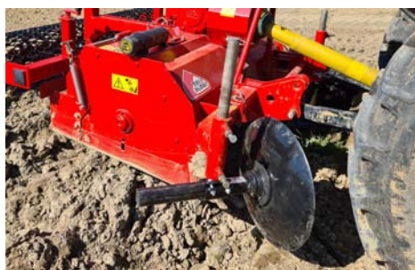
Option : Disques avant pour formation du sillon
