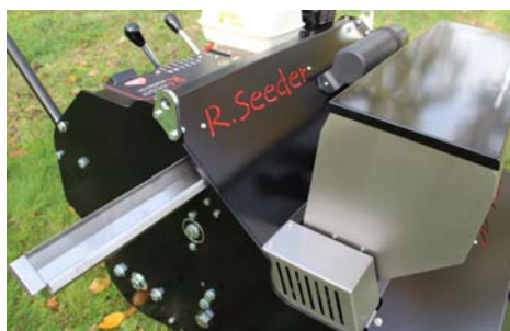
Auget pour l'égalonnage du dépôt de semences
