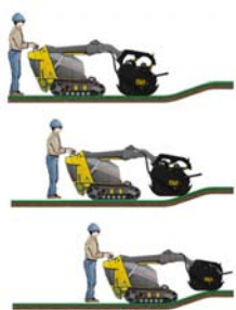
Système flottant de suivi de terrain
