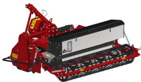
Option : Semoir inox à gazon à cannelures (SMC) ou gravitaire (SG)
