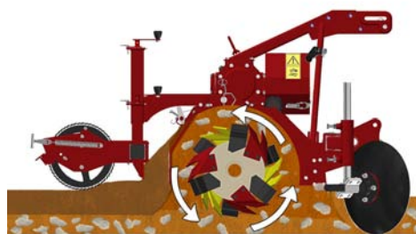
Principe de préparation du sol
