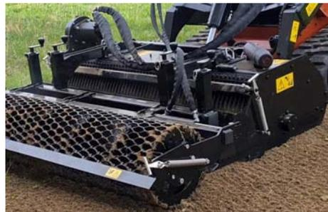
Option : Déplacement hydraulique du châssis rouleau
