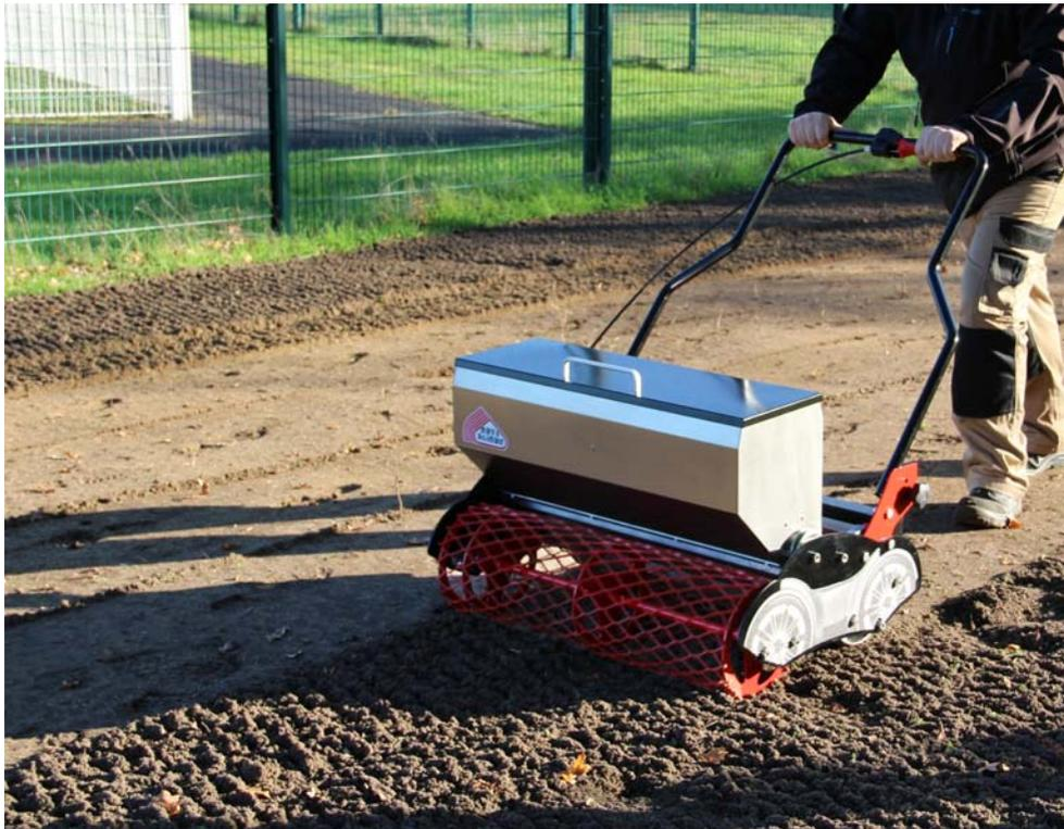
Le Rotadairon® SEEDCAR est un engazonneur manuel conçu pour le semis de tous les types de gazon (pâturins, fétuques ou ray-grass). Ce semoir par gravité est équipé d'un réglage de débit par secteur gradué. Pour un confort de travail, l'ouverture / fermeture du semis se fait depuis le guidon. Il permet aussi d'engazonner et rouler tous les « coins » de terrains étroits ou d'accès difficiles.
