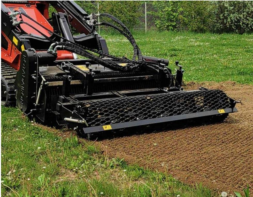
Ce préparateur de sols et enfouisseur est destiné aux chargeurs compacts hydraulique avec une plaque d'attelage de type Bobcat.
