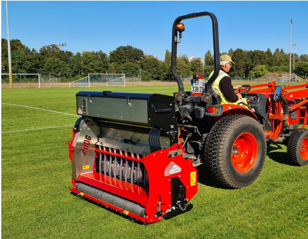
Ce regarnisseur permet d'effectuer vos opérations de sur-semis de façon optimum. Chaque ensemble disque / injecteur réalise une découpe nette et une dépose de la graine précise. Cette conception unique nous permet de vous proposer une machine compacte avec un poids contenu permettant la sélection d'un tracteur de moindre capacité de relevage.
