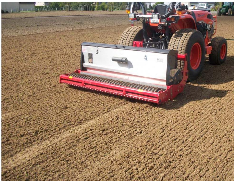
Ces engazonneurs ont été conçus pour semer la plupart des variétés de gazons comme les pâturages, les fétuques, ray-grass, etc... sur de grandes surfaces. Ils sont équipés d'un semoir à gravité et de deux rouleaux disques crénelés fonte, permettant un engazonnement en un seul passage. Ils s'utilisent sur terrain préalablement travaillé à l'aide d'un préparateur de sol/enfouisseur de pierres.
