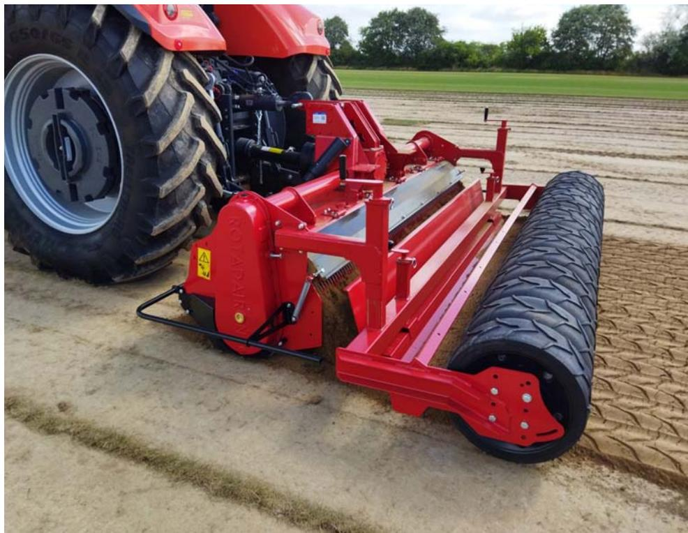
Ce préparateur de sols et enfouisseur de pierres permet la création ou la rénovation d'espaces verts en préparant le lit de semences avant l'engazonnement. La machine est multi-usage, elle permet de fraiser, d'enfouir (pierres, détrit, herbes ...), de niveler, de malaxer et de rouler la surface. L'utilisation se fait en direct ou sur un terrain préalablement décompacté en profondeur.
