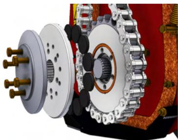
**Limiteur de couple hydraulique à pastilles en bout de rotor**
