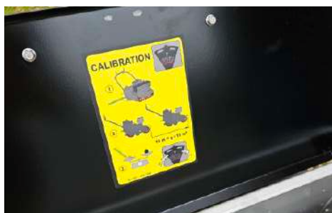
Auget pour l'étalonnage du dépôt de semences
