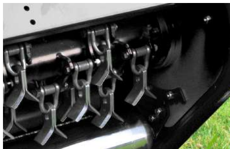
Montage en Y des couteaux sur manilles
