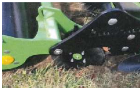
Option : coupe bordure par disque affûté
