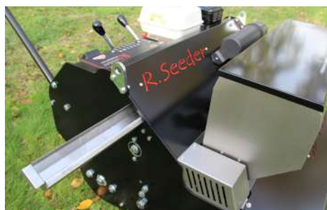
Auget pour l'étalement du dépôt de semences
