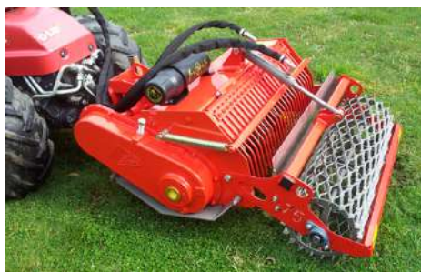
Option : Réglage de la profondeur de travail par vérin hydraulique
