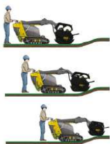
Système flottant de suivi de terrain
