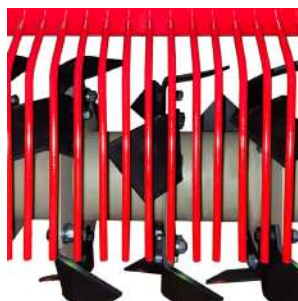
Lames anti-semelle (Brevet Rotadairon®)
