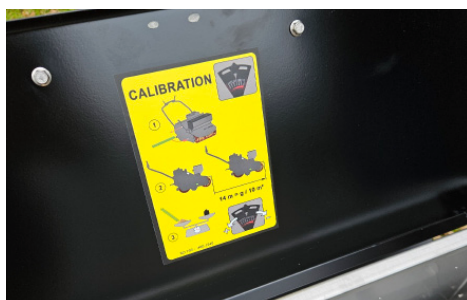
Auget pour l'étalonnage du dépôt de semences
