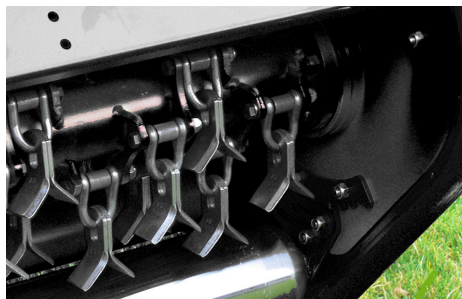
Montage en Y des couteaux sur manilles
