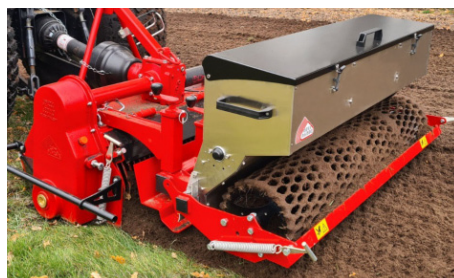
Option : Semoir inox gravitaire SG sur Stony 90 et SG 100 (Voir SG P.56)
