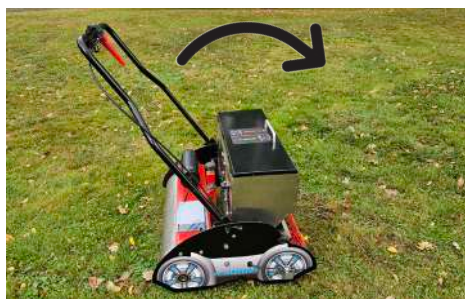
Guidon en position semis, basculable en position sur semis
