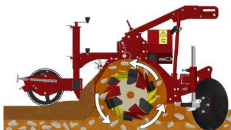
Principe de préparation du sol
