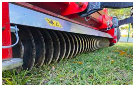
Disques tranchants pour action de stress des adventices
