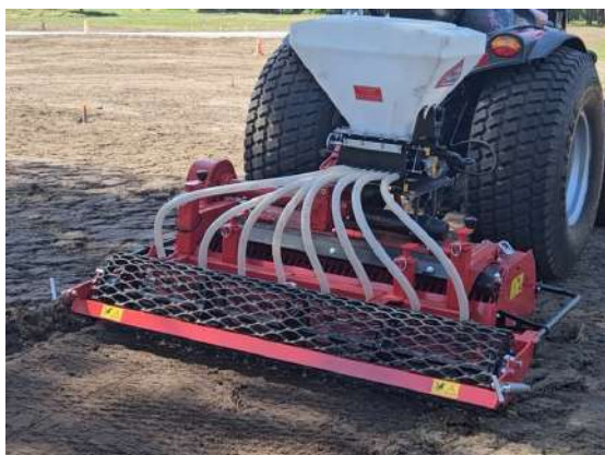
SCV sur préparateur de sol RD 130
