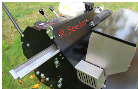
Auget pour l'étalement du dépôt de semences
