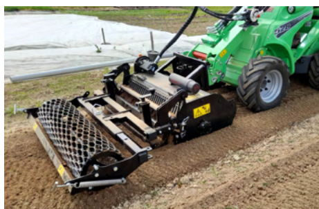
Possibilité de montage sur chargeuse articulée
