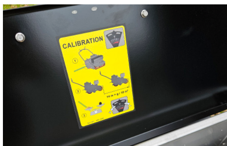
Auget pour l'étalonnage du dépôt de semences
