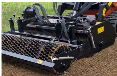
Option : Déplacement hydraulique du châssis rouleau
